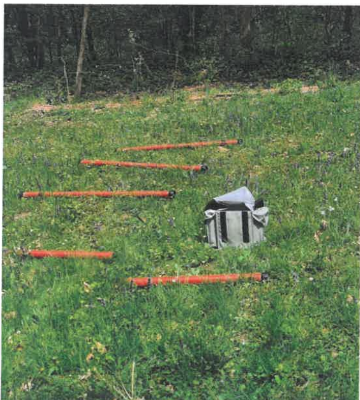
Slika 6. Prikaz sonde koje se koriste pri magnetotelurskom snimanju
